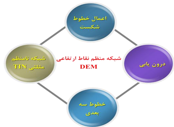
شکل ۲. فرایند ساخت DEM از اطلاعات برداری
