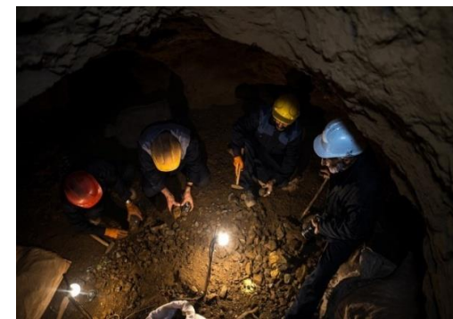
شکل ۱۳- عدم وجود نور کافی به هنگام فیروزه جوری عمق ۷۰ متری
