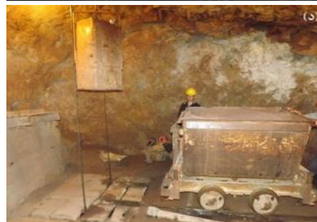
شکل ۱۹: عدم رعایت حداقل‌های ایمنی حین استفاده از تجهیزات استخراجی در معدن فیروزه. الف) تجهیزات فرسوده/ عدم رعایت حداقل‌های ایمنی توسط اپراتور هنگام کار با دستگاه، ب) جایگیری خطرناک اپراتور بالای چاه استخراجی بدون هیچگونه تجهیزات فردی، ج) استفاده از نردبان‌های دست‌ساز با میلگرد بدون استفاده از تجهیزات نگهدارنده و د) تجهیزات فرسوده/ عدم استفاده از علائم هشدار دهنده در چاه استخراجی
