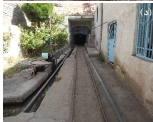
شکل ۱۰ الف، ب، ج، د- مسیر جوی آب جاری از انتهای تونل اصلی استخراجی در معدن فیروزه که در حاشیه داخلی تونل و به سمت خارج آن جریان می‌یابد.
