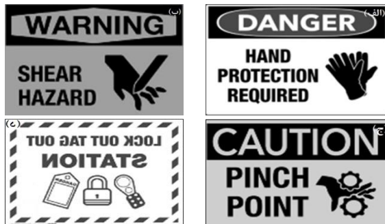
شکل ۷- نمونه‌ای از برخی تابلوهای استاندارد ایمنی در معادن. الف) برای تجهیزات خطر/ نیاز به محافظت از دستها، ب) هشدار/ خطر بریدگی اعضاء بدن، ج) احتیاط/ نقطه درگیری چرخ دنده، د) استراتژی Lockout/Tagout https://www.creativesafetysupply.com/content/landing/mining/index.html January, 2019
