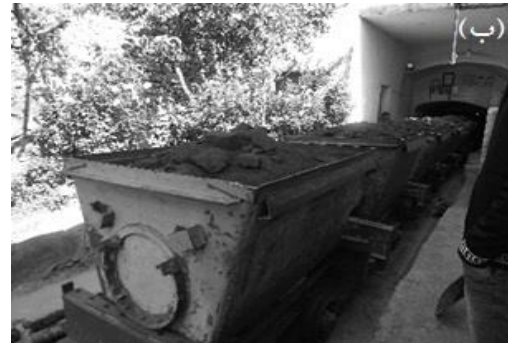
شکل ۱۲ الف و ب - حرکت گاری‌های حمل باطله های معدن فیروزه بدون هیچگونه علائم هشدار دهنده
