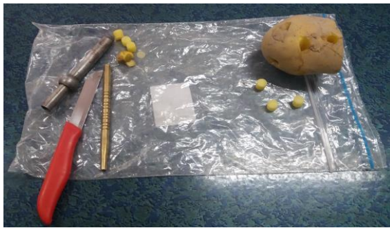
شکل ۱- برش و آماده سازی نمونه سبب زمینی جهت انجام آزمایش
