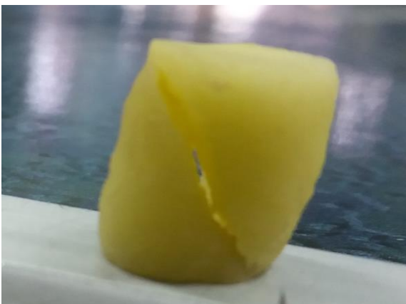
شکل ۳- گسیختگی نمونه سبب زمینی بعد از اعمال نیروی فشاری
