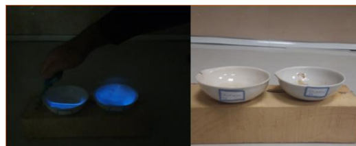
شکل ۹- تست شعله نمونه قلیایی ۸ زمان ۴۵ دقیقه و قلیایی ۱۲ زمان ۴۵ دقیقه
