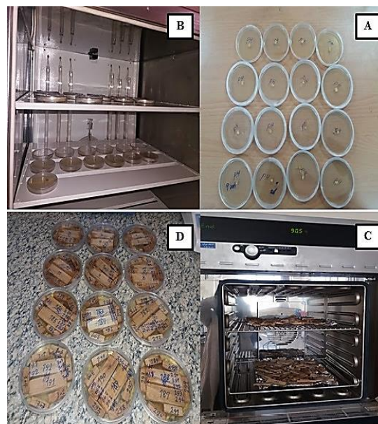
شکل ۲- مراحل انتقال نمونه‌های قارچ به ظروف کشت (A)، نگهداری ظروف شیشه‌های کشت در دستگاه انکوباتور (B)، خشک کردن نمونه‌ها (قبل از معرض گذاری) جهت قرار گیری در محیط کشت (C) و انتقال نمونه‌های چوبی به ظروف حاوی هیف‌های قارچ (D)
