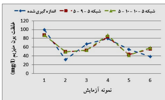
شکل 5- مقایسه نتایج شبیه سازی پارامتر غلظت منیزیم برای نمونه های آزمایش
