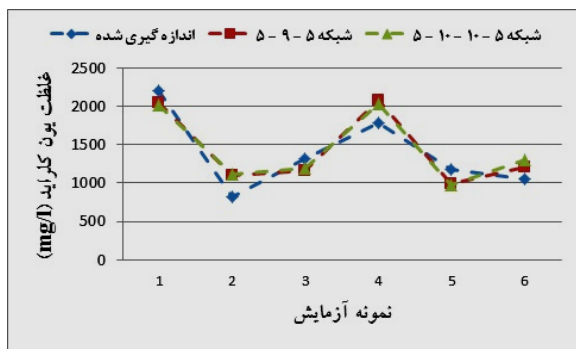
شکل ۷- مقایسه نتایج شبیه سازی پارامتر غلظت کلراید برای نمونه های آزمایش
