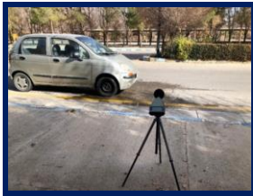
شکل ۳- جزئیات دستگاه صوت سنج و اندازه‌گیری شدت صوت در آسفالت مرطوب و خشک ( ۵۰ و ۳۰ کیلومتر بر ساعت)
