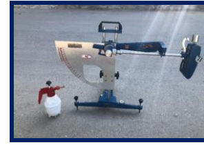
شکل ۶- اندازه گیری اصطکاک آسفالت خیس و خشک با استفاده از پاندول انگلیسی
