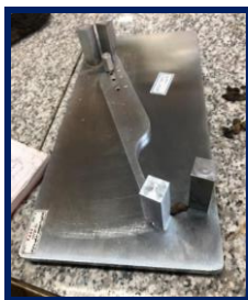
شکل ۵- تعیین درصد وزنی سنگ‌دانه‌های دراز و پولکی با استفاده از کولیس تناسبی
