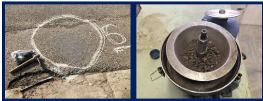
شکل ۴- کندن نمونه آسفالتی و قرارگیری هر یک از ۹ نمونه در استراکشن
