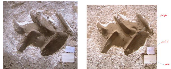
شکل ۲- سطح تماس تایر با خاک رس (سمت چپ) و ماسه ای (سمت راست)
