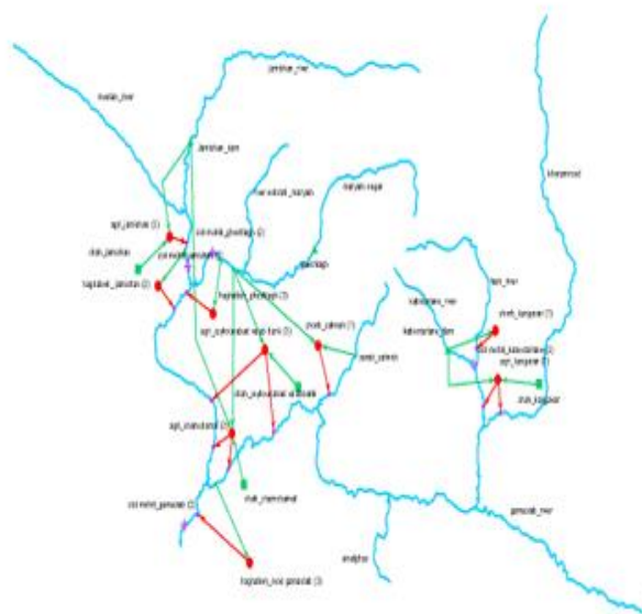
شکل ۳- شماتیک منابع و مصارف حوضه آبریز گاماسیاب در مدل WEAP
