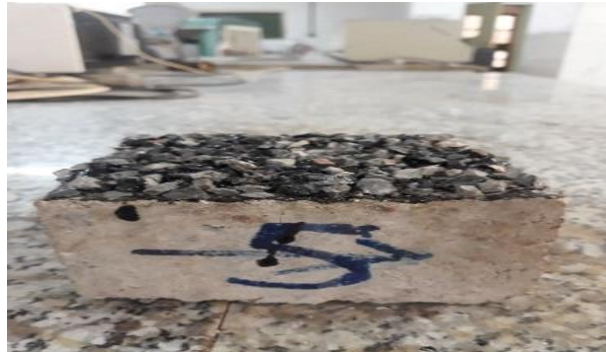
شکل ۵- چپ‌سیل اجراشده حاوی سرباره فولادی با دانه‌بندی نوع د بر روی نمونه بتنی
