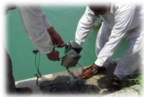
شکل ۲- استفاده از گرب جهت نمونه برداری از رسوبات کف بستر مهمترین آزمایشات انجام گرفته بر روی رسوبات شامل دانه بندی رسوبات، کلسی متری، مطالعات کانی شناسی و نیز تجزیه عنصری به روش ICP. جهت تعیین قطر ذرات ریز دانه نیز از
