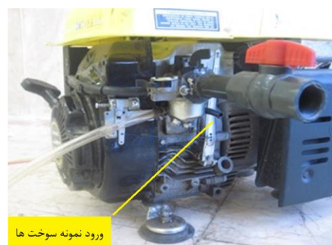
شکل ۱- محل ورودی سوخت و ورودی هوا به موتور تحت آزمون
