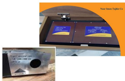
شکل ۲- دوربین تصویربرداری فراتیفی در محدوده ۴۰۰-۱۱۰۰ نانومتر
