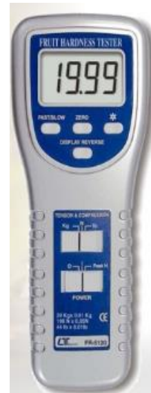
شکل ۳- دستگاه سفتی سنج برای آزمون مخرب و تعیین سفتی پرتقالها
