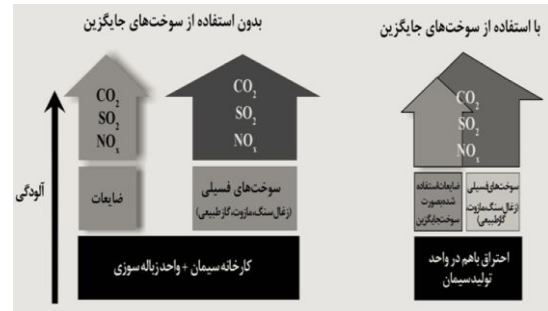
شکل ۱۰- دلیل جایگزینی سوخت کمکی و صنعت سیمان به جای زباله سوزهای شهری
