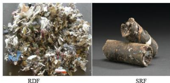
شکل ۲- نمونه ای از سوخت های SRF و RDF تولید شده
