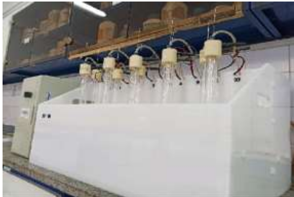
شکل ۴- دستگاه اتوماسیون اندازه گیری هدایت هیدرولیکی اشباع خاک به روش بارافتان
