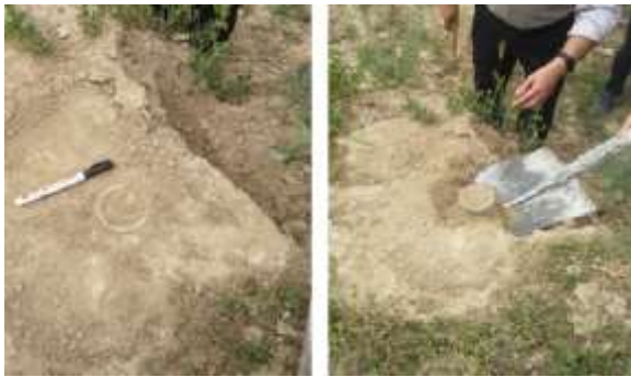
شکل ۳- نمونه برداری از لایه سطحی خاک توسط سیلندر نمونه برداری خاک
