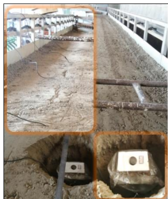
شکل ۴- قرارگیری تنش سنج‌ها در خاک
