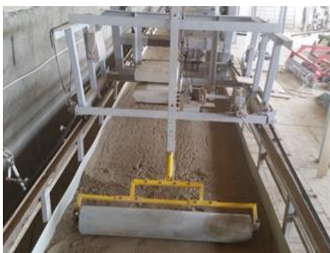
شکل ۱- مراحل آماده سازی خاک (ج) مرحله غلتک زنی
