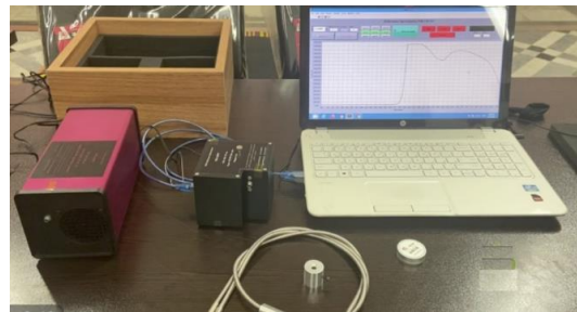
شکل ۱. تجهیزات سخت افزاری اسپکترومتر بازتابی مدل NIR-GR ۹۱۷
