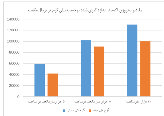
شکل ۷- مقادیر نیتروژن اکسید در گرم کن سنتی و جدید در دبی های مختلف ( Mg/Nm^3 )
