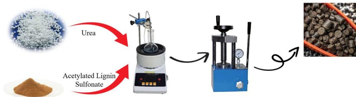
شکل ۶. تولید کود اوره آهسته‌رهش به روش ماتریس با استفاده از لیگنین سولفونات استیل‌شده (Mohammadzadeh et al., 2024; Moradi, Shayesteh, & Mohammadzadeh, 2022)
