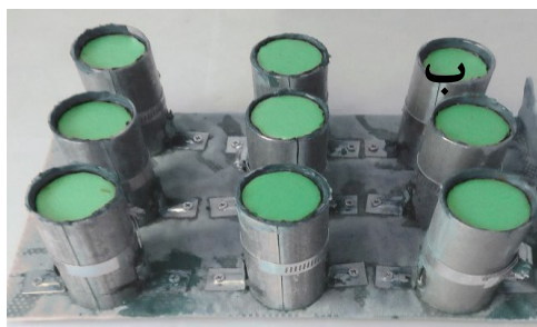
شکل ۱۰- قالبهای تهیه شده از مخلوط باکتری و کلرید کلسیم (الف) قالبهای خالی (ب) قالبهای پر شده
