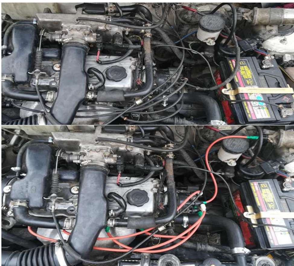
شکل ۳. نمایی از قبل و بعد از نصب وایرهای بهینه بر روی خودرو پراید
