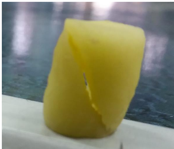
شکل ۲- گسیختگی نمونه سیب زمینی بعد از اعمال نیروی فشاری
