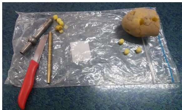
شکل ۱- برش نمونه و آماده سازی جهت آزمون فشار
