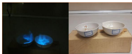
شکل ۸- تست شعله نمونه قلیایی ۱۲ زمان ۳۰ دقیقه و قلیایی ۸ زمان ۳۰ دقیقه
