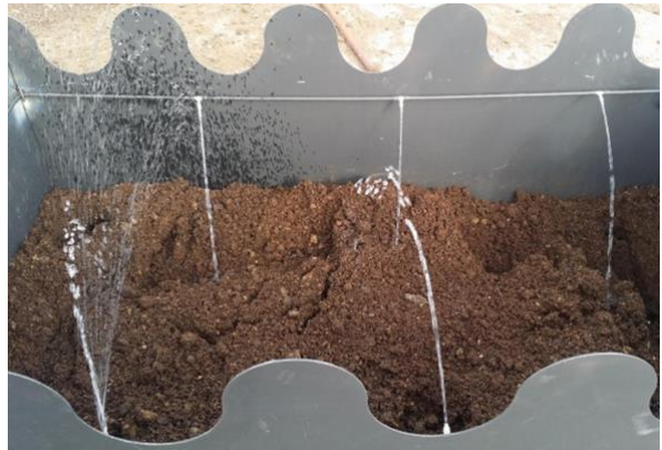
شکل ۶- عملکرد نازل‌های آب پاش طی کالیبره کردن دبی و زمان پاشش
